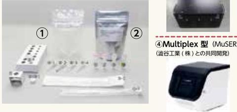
ました。私たちのキットは、PCR検査の前処理を通常より1時間ほど早く行うことができるものです。であれば、PCRも早くできるようにしないとキットの性能を十分に発揮できないと考え、30分くらいでPCRが終了する測定機MuSERを共同開発しました。また、非常に頑丈で、持って歩けるPCR測定機の開発に着手し、通いの獣医さんが応診時に畜産現場へ車に積んでいって、バッテリーで駆動して、農場の駐車場、つまりオンサイトでPCR検査ができる測定機CHIMを共同開発しました(図7)。
